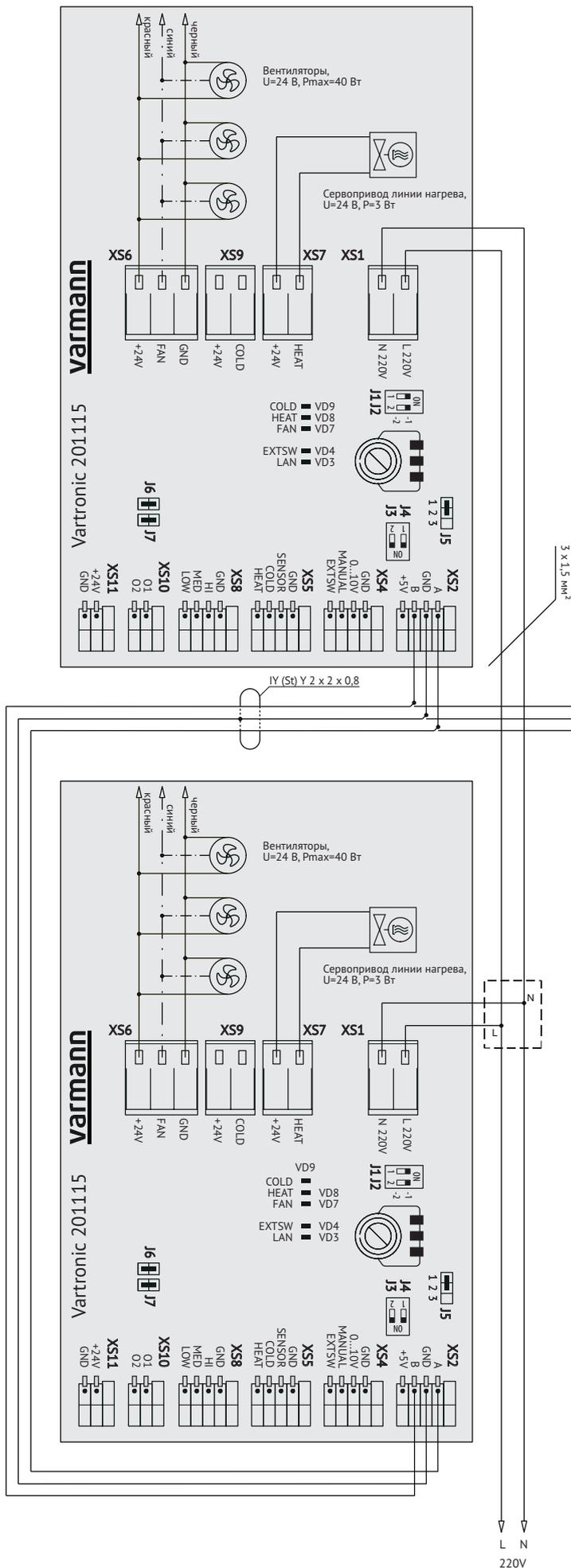
Настенный регулятор Vartronic 703201/703202 осуществляет регулирование температуры воздуха в помещении посредством плавного изменения скорости вращения вентиляторов и управления термоэлектрическим сервоприводом для изменения расхода теплоносителя, проходящего через теплообменник конвектора.
