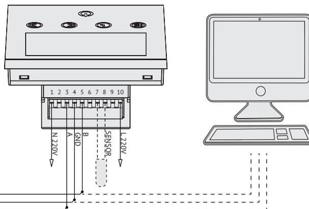
В блоках регулирования Vartronic 201115 используется совместимый последовательный интерфейс RS-485. Блоки регулирования соединяются, используя технологию «главный-подчиненный», при которой только одно устройство (настенный регулятор или HOST-PC) может инициировать передачу данных и делать запрос.
